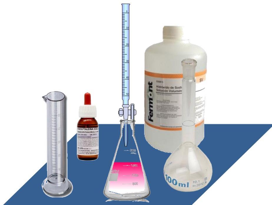
1. Se mide con la probeta 20 mL de la base (NaOH) que queremos valorar y se vierten en un Erlenmeyer.
