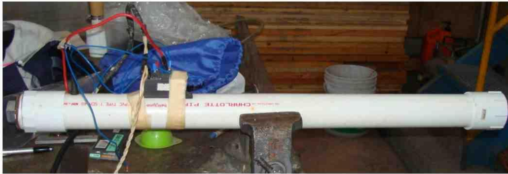
Figura 2: Cañón a base de combustión y presión. A pesar de funcionar, no fue utilizado por la inconsistencia de los anillos que generaba y por su innecesaria complejidad. ✓
