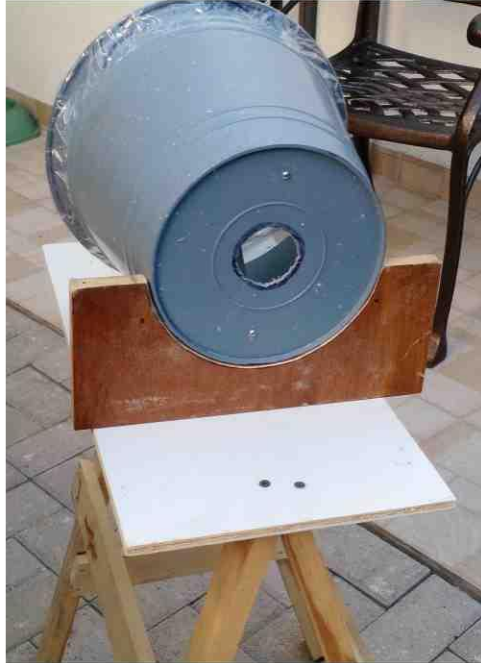
Figura 4: Cañón utilizado. Se construyó una base de madera para tener el cañón a la altura adecuada y un soporte extra para mantener al plano de la boca del cañón perpendicular al piso.
