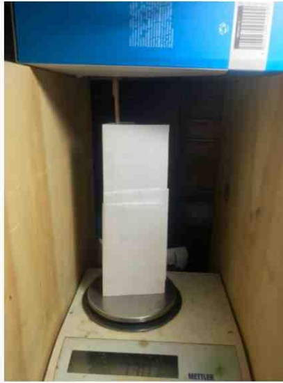
Figura 2. Arreglo experimental, con solenoide arriba, anillo sobre el riel y abajo la báscula digital.
