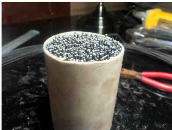
Figura 4. Pedazos de alambre recocido dentro del tubo de PVC, como núcleo del solenoide. ✓
