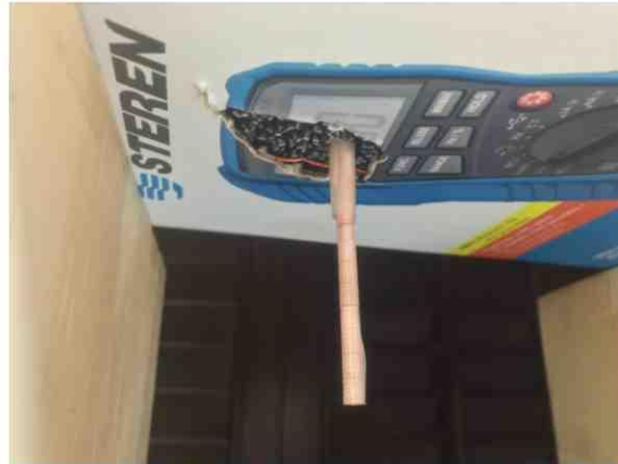
Figura 3. Palillo con papel milimétrico alrededor para medir la distancia entre el anillo y la base del solenoide.
