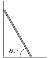
**A.4.** Un puente levadizo de madera mide 5 m y tiene una masa de 400 kg, y está dispuesto como indica la figura. Calcule la tensión del cable y las reacciones que ejerce la bisagra.
