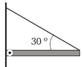
**A.2.** Una viga de 50 kg está apoyada horizontalmente sobre dos apoyos simples, como indica la figura. Calcular la fuerza que ejerce cada soporte. ( $g = 9,8 \text{ N/kg}$ )
