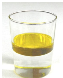
El aceite flota en el agua, ya que su densidad es menor.
