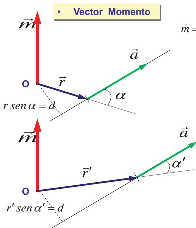
$$\vec{m} = \vec{r} \times \vec{a} = \begin{pmatrix} \vec{i} & \vec{j} & \vec{k} \\ r_x & r_y & r_z \\ a_x & a_y & a_z \end{pmatrix} = m_x \vec{i} + m_y \vec{j} + m_z \vec{k}$$
